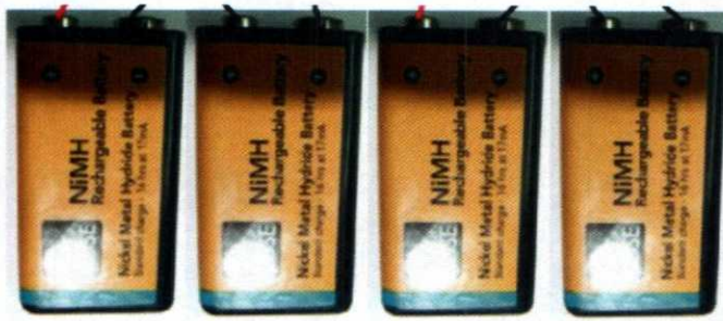
4 x 9 volt batteries = 36 volts
